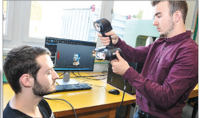
Les étudiants du CPNV Sylvain Bardera (à g.) et Valentin Claret font la démonstration du scannage 3D d'un visage, grâce à de la lumière blanche. Photos: Carole Alkabes
