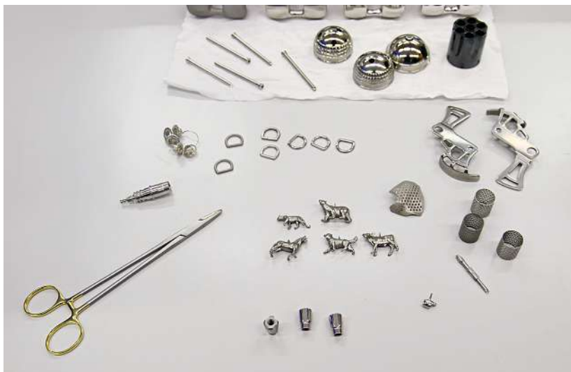
Exemples de pièces, principalement dédiées au secteur médicale, obtenues par fabrication additive métallique avec les machines d'Addipole.
