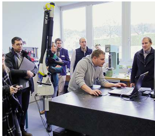
Démonstration de scannage d'une pièce avec un scanner laser dans le local de métrologie d'Addipole.
